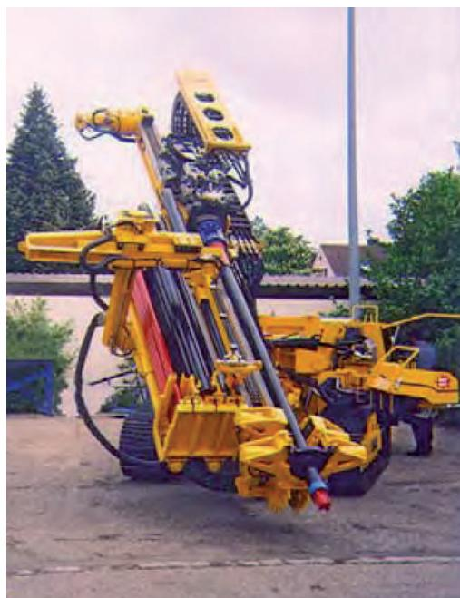
1. Mašina za ankerovanje / Anchoring machinery
