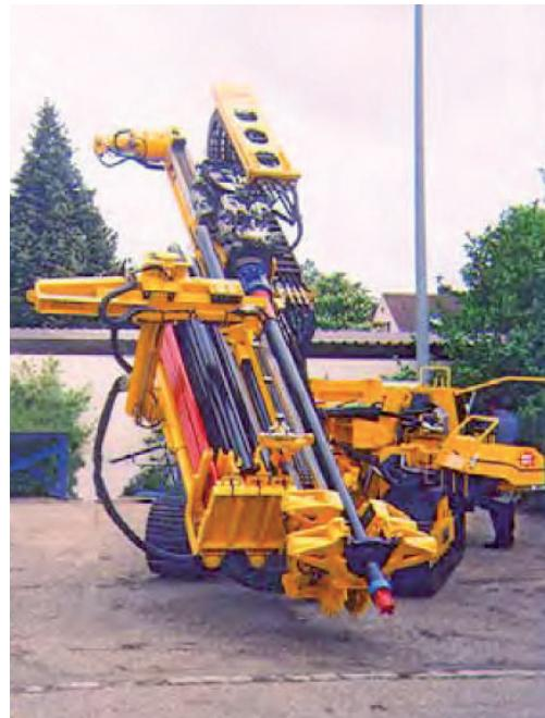
1. Mašina za ankerovanje / Anchoring machinery
